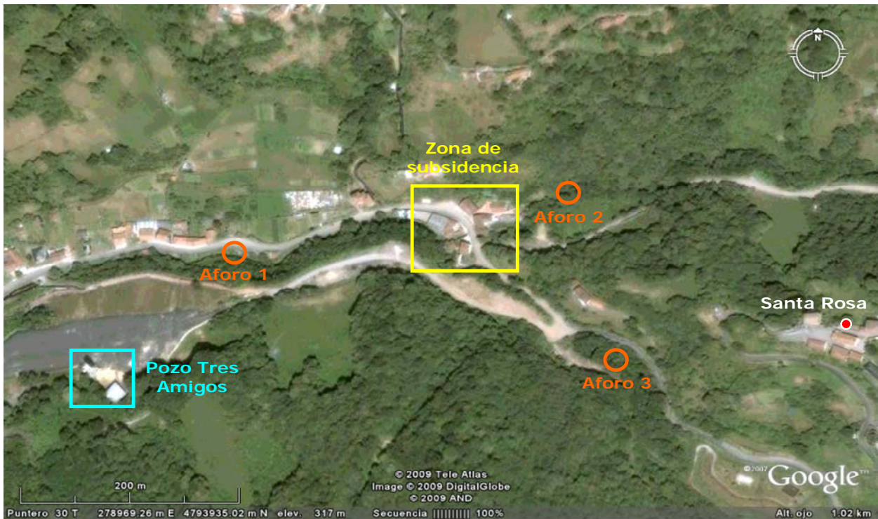
Vista aérea en Google Earth del Pozo Tres Amigos, del área afectada por subsidencia y de los 3 puntos de aforo realizados.
