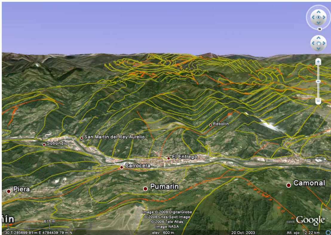
Figura 1-19.- Límites de paquetes y fallas 3D sobre imagen tridimensional de Googlearth
